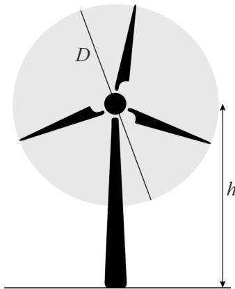
Neben der Masthöhe hängt die Leistung einer Windmühle auch vom Rotordurchmesser ab. Diese beiden Faktoren spielen gleichzeitig eine Rolle. Dies spiegelt sich in der Formel für die Leistung wider:
