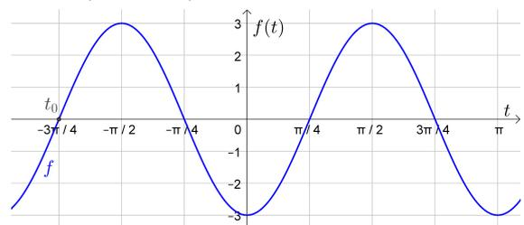
Ausgehend von  $t = 0$  drehen wir die Zeit so weit zurück, bis der Zeiger im Zeigerdiagramm waagrecht nach rechts zeigt. Dieser Zeitpunkt  $t_0 = -\frac{3 \cdot \pi}{4}$  ist oben eingezeichnet.
