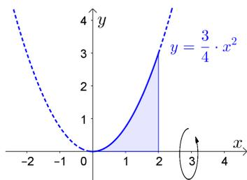
$$V_x = \int_0^2 \underbrace{\pi \cdot y(x)^2}_{\substack{\text{Flächeninhalt} \\ \text{vom Querschnitt} \\ \text{an der Stelle } x}} dx$$
