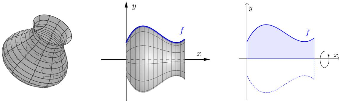
Ihre Mantelfläche kann nämlich durch Rotation eines Funktionsgraphen um die  $x$ -Achse erzeugt werden. Mithilfe der **Integralrechnung** können wir das Volumen solcher Rotationskörper berechnen.
