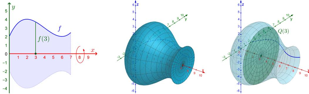
Der Querschnitt mit  $x = 3$  ist ein Kreis mit Radius  $f(3)$  und Flächeninhalt  $Q(3) = \pi \cdot f(3)^2$ .
