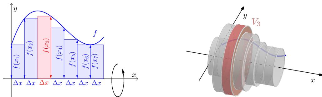
Stelle mithilfe von  $x_3$ ,  $\Delta x$  und  $f$  eine Formel für das Volumen  $V_3$  des markierten Drehzylinders auf:
