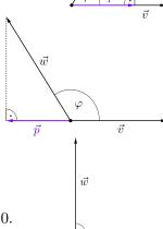
iii) Rechts schließen die Vektoren  $\vec{v}$  und  $\vec{w}$  einen rechten Winkel ein. In diesem Fall gilt:  $\vec{v} \cdot \vec{w} = 0$ Die Normalprojektion  $\vec{p}$  ist in diesem Fall der Nullvektor mit der Länge 0.
