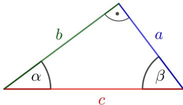
$$\sin(\alpha) = \frac{\text{Gegenkathete von } \alpha}{\text{Hypotenuse}} = \frac{a}{c} \quad \text{„Sinus von } \alpha\text{“}$$
