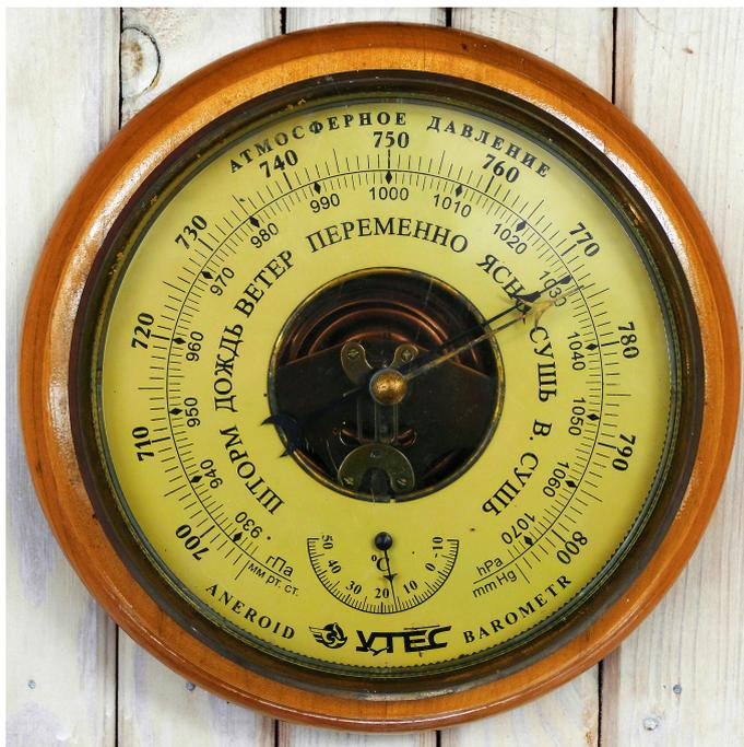
ABBILDUNG 17. Mit diesem russischen Barometer sind Messungen in hPa und mmHg (das entspricht in sehr guter Näherung der Einheit Torr) möglich.
