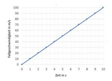
ABBILDUNG 18. Zusammenhang zwischen der Fallzeit und der Fallgeschwindigkeit bei einem freien Fall ohne Luftwiderstand.
