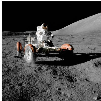
ABBILDUNG 4. Solche Elektroautos wurden bei den Mondmissionen 1971 und 1972 von der NASA verwendet. Die Maximalgeschwindigkeit lag bei nur  $13 \text{ km/h}$ . [4]
