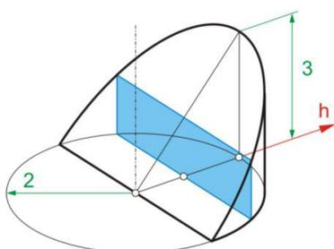
Der dargestellte Teil eines Drehzylinders liegt zwischen zwei Ebenen. Sein Volumen  $V$  ist zu berechnen.
