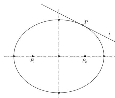
**Konstruktion 1** (Ellipsentangente). Konstruiere die Tangente im Punkt  $P$  einer Ellipse mit Brennpunkten  $F_1$  und  $F_2$  und Hauptachsenlänge  $2a$ .
