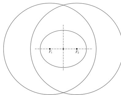
**Konstruktion 2** (Ellipsenkonstruktion mittels Gegenkreises). Es seien die beiden Brennpunkte  $F_1$  und  $F_2$ , sowie die Hauptachsenlänge  $2a$  einer Ellipse gegeben. Konstruiere die Ellipse punktweise mittels eines Gegenkreises.
