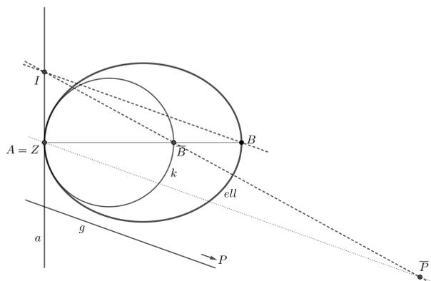
3) Dies ergibt die Parallele zu  $g$  durch  $B$ , die die Achse  $a$  im Hilfspunkt  $I$  scheidet. Die Gerade  $BP$ , auf der auch  $I$  liegt, geht also bei der Kollineation in die Gerade  $I\bar{B}$  über, und wir erhalten  $\bar{P}$  als Schnittpunkt des Kollinationsstrahls durch  $P$  mit der Geraden  $I\bar{B}$ .
