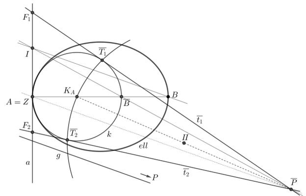
5) Nachdem wir die beiden Berührungspunkte  $\bar{T}_1$  und  $\bar{T}_2$  kennen, erhalten wir die beiden Tangenten  $\bar{t}_1$  und  $\bar{t}_2$  als Verbindungsgeraden von  $\bar{P}$  mit  $\bar{T}_1$  bzw.  $\bar{T}_2$ . Ihre Schnittpunkte mit  $a$  werden mit  $F_1$  bzw.  $F_2$  bezeichnet. Diese sind aufgrund ihrer Fixpunkteigenschaft bei der Kollineation auch Punkte von  $t_1$  bzw.  $t_2$ .
