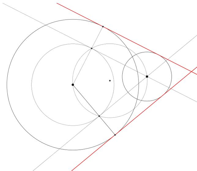
Diese Konstruktionsvorschrift funktioniert genau dann, wenn nicht einer der Kreise zur Gänze im Inneren des anderen Kreises liegt.
