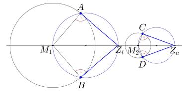
Erkläre, warum die Gerade  $BZ_i$  den Kreis  $k_2$  in  $B'$  berührt bzw. warum die Gerade  $CZ_a$  den Kreis  $k_1$  in  $C'$  berührt. Zentrische Streckung mit Faktor  $\frac{r_1}{r_2}$  mit Zentrum  $Z_a$  bildet  $C$  auf  $C'$  ab, der rechte Winkel bleibt erhalten und  $M_1C' = r_1$ . Somit ist  $Z_aC'$  Tangente an  $k_1$ . Analog:  $Z_iB'$  ist Tangente, da  $M_2B' \perp M_2B'$  und  $M_2B' = r_2$ .
