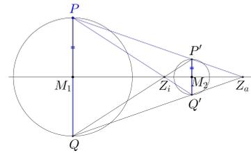
Erkläre die Konstruktion der Berührungspunkte  $A$ ,  $B$ ,  $C$  und  $D$  der Tangenten durch die Ähnlichkeitszentren an die jeweiligen Kreise. Thaleskreis über Sehne  $M_1Z_i$  schneidet den Kreis  $k_1$  in  $A$  und  $B$  und  $\angle M_1AZ_i = \angle Z_iBM_1 = 90^\circ$ . Somit  $Z_iA \perp CM_1$  und damit ist  $Z_iA$  Tangente an  $k_1$  (Tangente steht normal auf Berührungsradius). Analog für  $Z_iB$ ,  $Z_aC$  und  $Z_aD$ .
