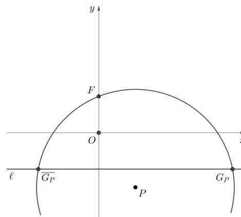
3) Die Tangente  $t_P$ , die durch den Gegenpunkt  $G_P$  bestimmt wird ist dann die Streckensymmetrale von  $G_P F$ , und somit normal zu dieser Strecke. Der Berührungspunkt  $P$  von  $t_P$  mit der Ellipse liegt, wie schon auf dem [Grundlagenblatt – Parabeltangenten](#) besprochen, auf der Normalen zu  $\ell$  durch  $G_P$ . Wir erhalten  $P$  daher als Schnittpunkt dieser Normalen mit  $t$ .
