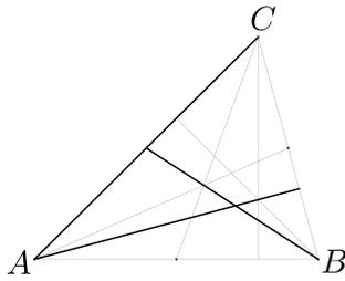
1) *Als ersten Schritt zeichnen wir eine Strecke AC der Länge  $b$ . Da die Höhe durch A normal zur Geraden  $BC = H_aC$  steht, gilt  $\angle CH_aA = 90^\circ$ , womit  $H_a$  auf dem Thaleskreis über der Strecke AC liegt. Der Mittelpunkt dieses Thaleskreises ist der Mittelpunkt  $M_b$  der Strecke AC. Da aber  $H_a$  von A den Abstand  $h_a$  hat, können wir  $H_a$  als Schnittpunkt dieses Thaleskreises mit dem Kreis mit Mittelpunkt A und Radius  $h_a$  konstruieren.*
