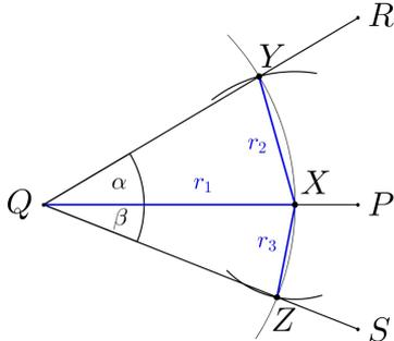
1) Zeichne mit dem Zirkel einen Kreisbogen mit Mittelpunkt  $Q$  und „nicht zu großem“ Radius  $r_1$  (kürzer als  $PQ$ ). Die Schnittpunkte mit  $PQ$ ,  $PR$  und  $PS$  seien der Reihe nach  $X$ ,  $Y$  und  $Z$ .
